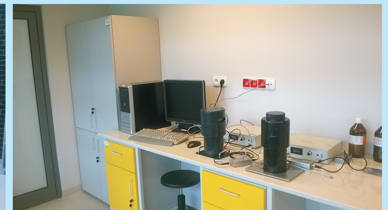
Zmodernizowany w Gliwicach scyntylacyjny spektrometr promieniowania beta ICELS skonstruowany przez prof. P. Theodorssona z Islandii
